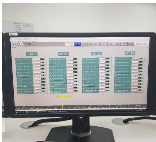
รูปที่ 3 หน้าจอบระบบ DCS และการตั้งเตือนที่หน้าจอ
